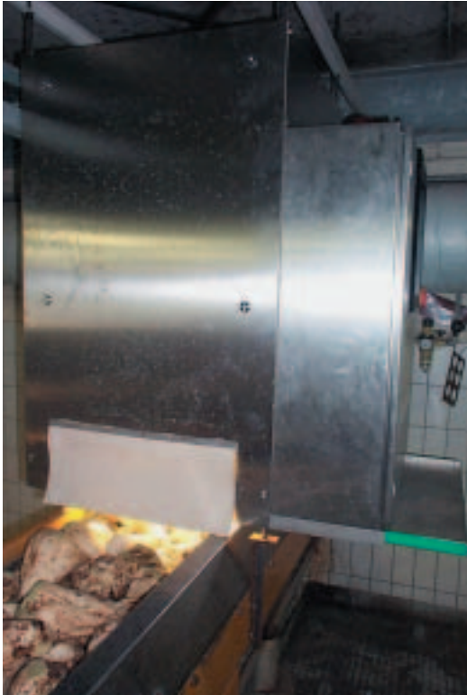
Het opnamesysteem voor de beeldverwerking, geplaatst boven de transportband. Bovenin bevindt zich de camera. In een apart compartiment rechts bevindt zich de computer.
